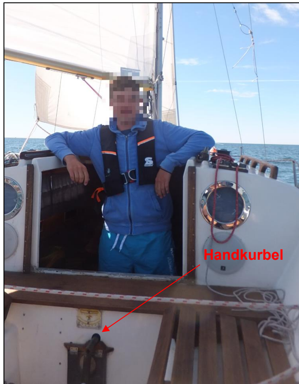
Abbildung 30: Handkurbel für das Schwert 78
