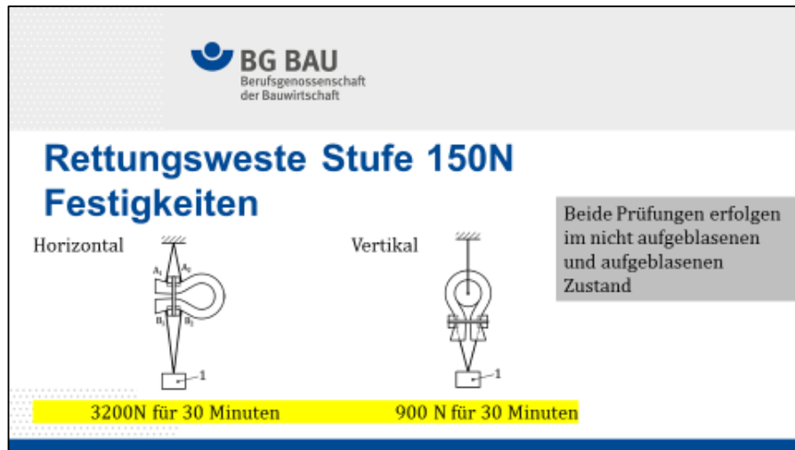
Abbildung 50: Festigkeitsanforderungen für Rettungswesten der Stufe 150 N 135
