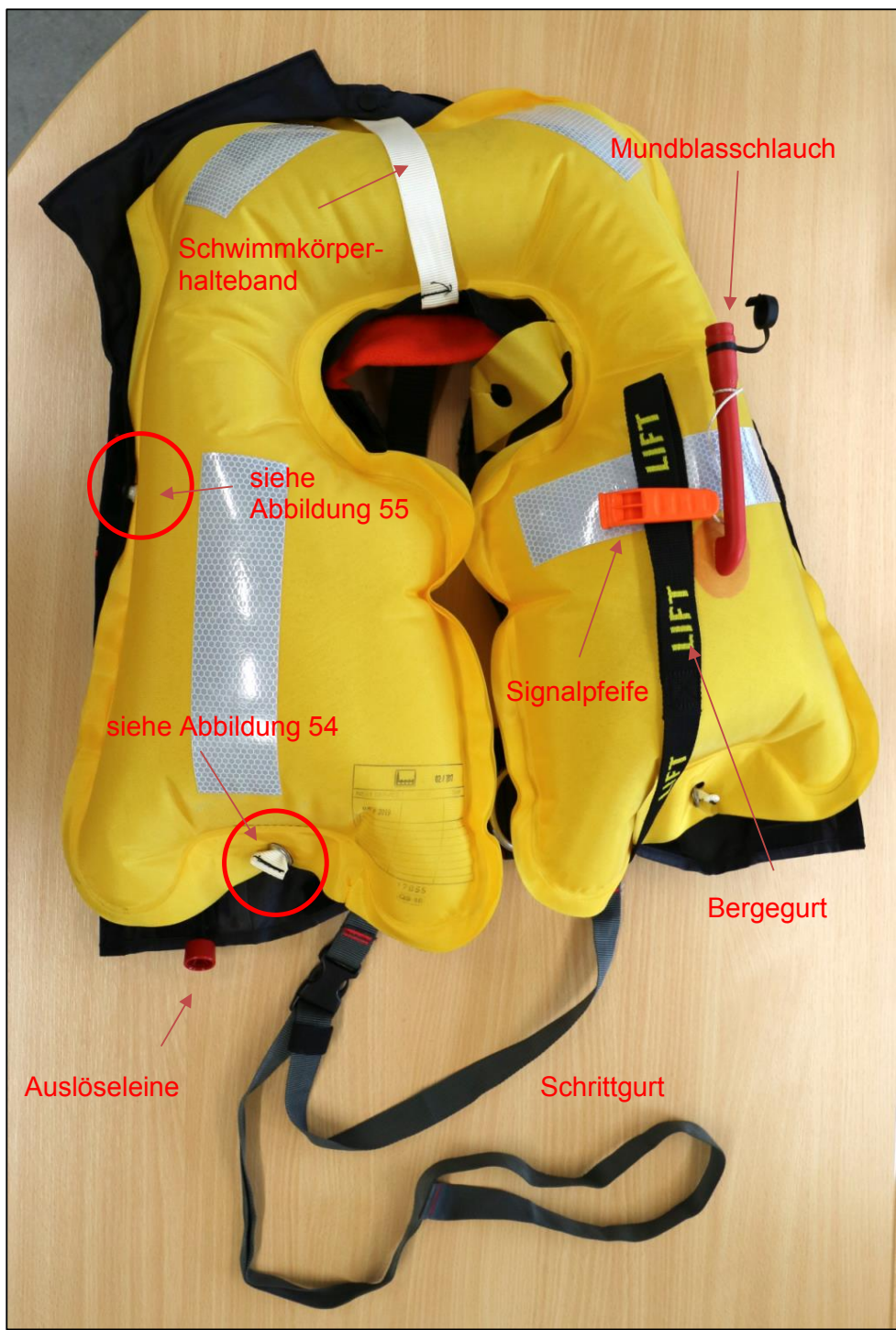
Abbildung 53: Ultra AX 150 mit Harness (Auftriebskörper aufgeblasen) 142
