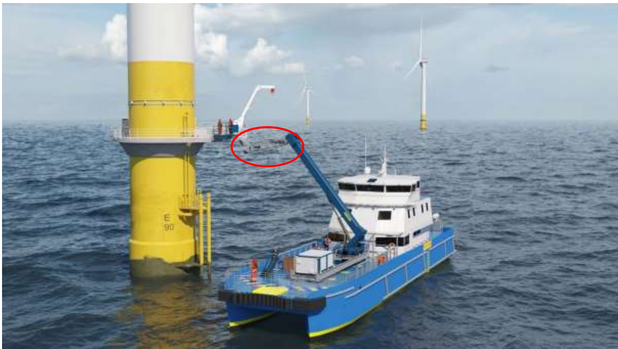
Abbildung 33: Krangeführte, seegangskompensierende Gangway 101
