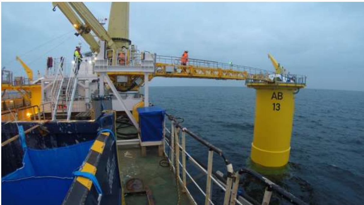
Abbildung 31: Seegangskompensierende Gangway für den Überstieg auf ein Offshore-Windradfundament 99
