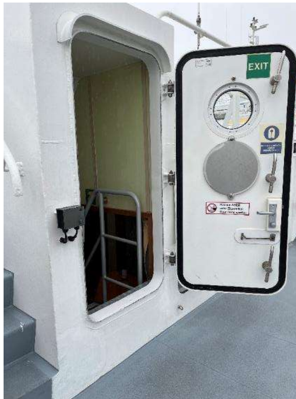
Abbildung 12: Achterer Eingang in die Aufbauten mit hohem Einstieg 25
