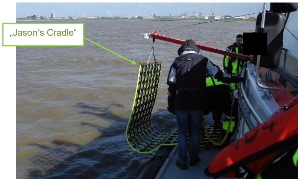
Abbildung 23: Klarmachen der Rettungseinrichtung eines Lotsenboots 61 (Hier ein sog. „Jason's Cradle“)
