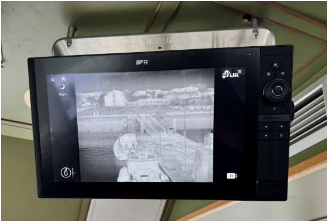
Abbildung 44: Wärmebildkamera auf der BORKUM 132
