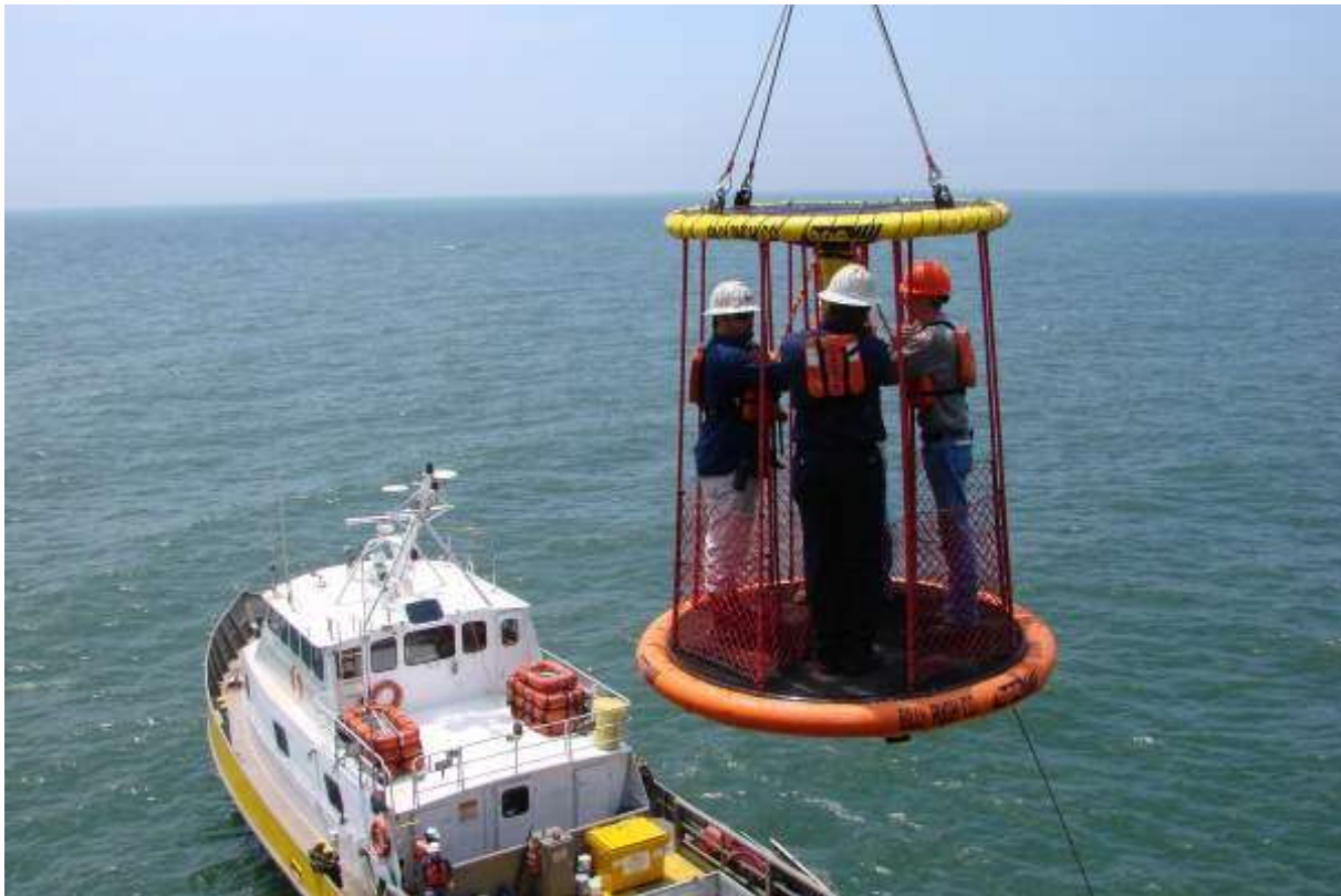
Abbildung 32: Lift für Offshore-Personaltransfer 100
