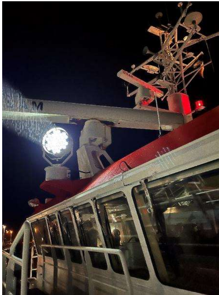
Abbildung 9: Position des Suchscheinwerfers auf dem Peildeck der BORKUM (vordere Brückenfenster) 20
