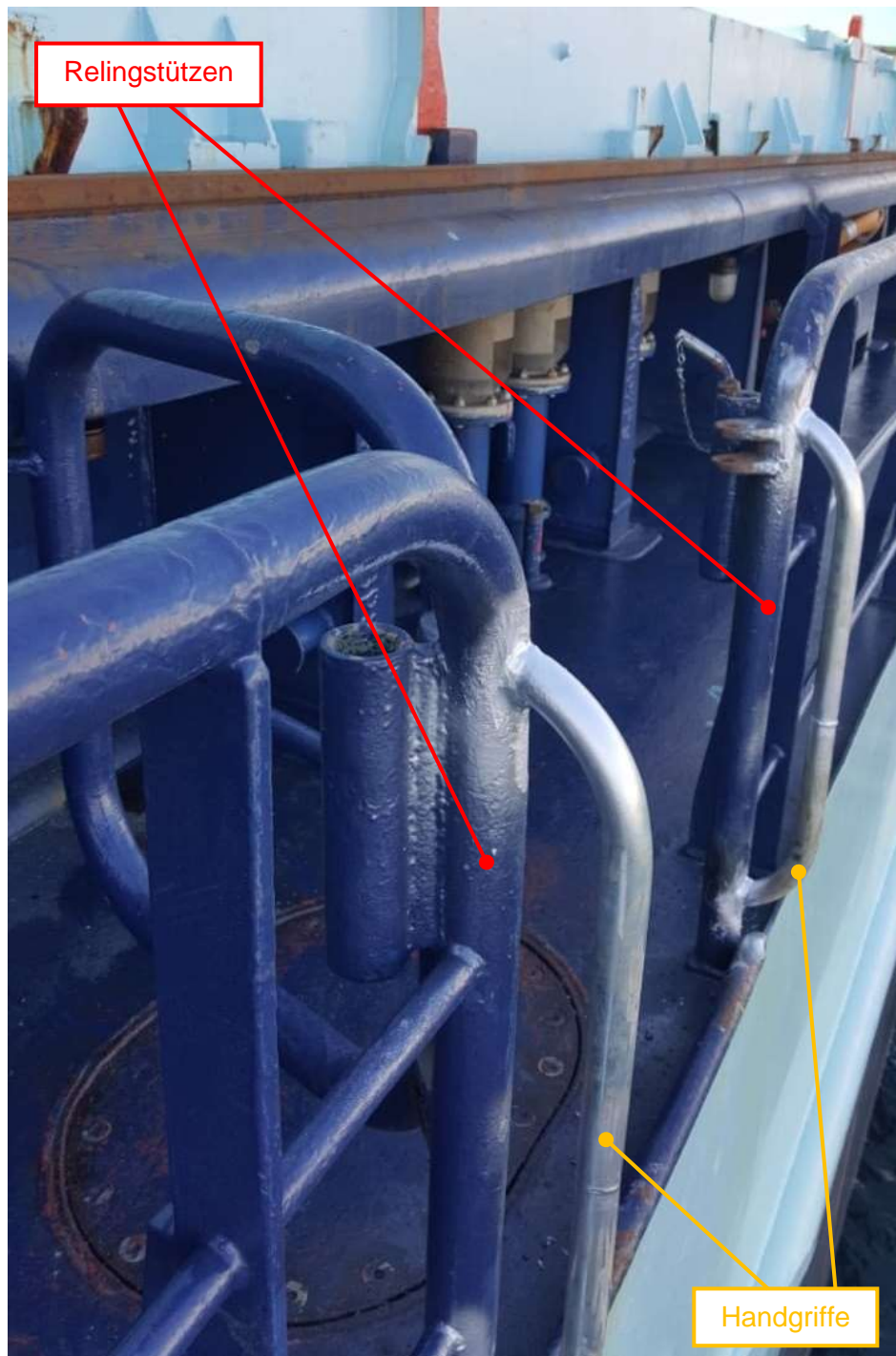
Abbildung 39: Nachgerüstete, geeignete Handgriffe 121
