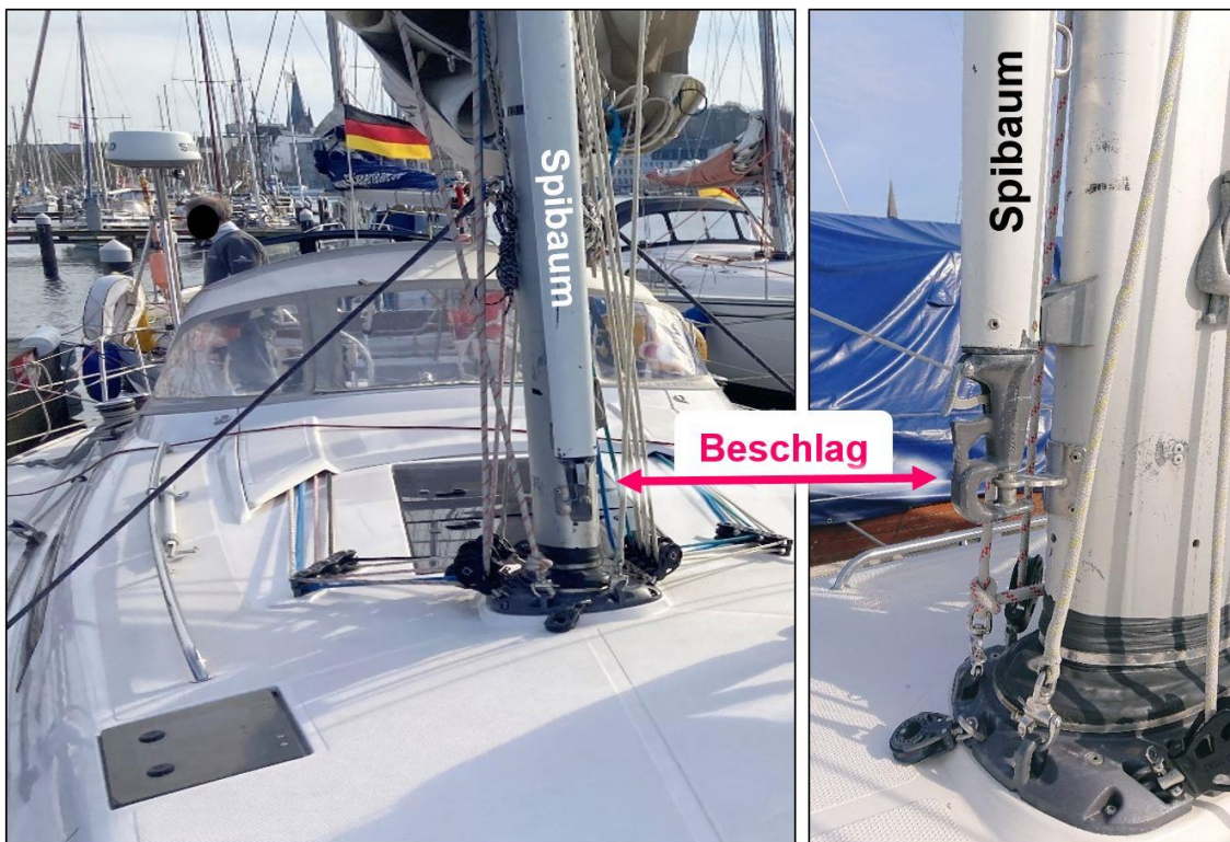
Abbildung 5: Am Mast befestigter Spinnakerbaum, wo sich die Schot verhakete 23
