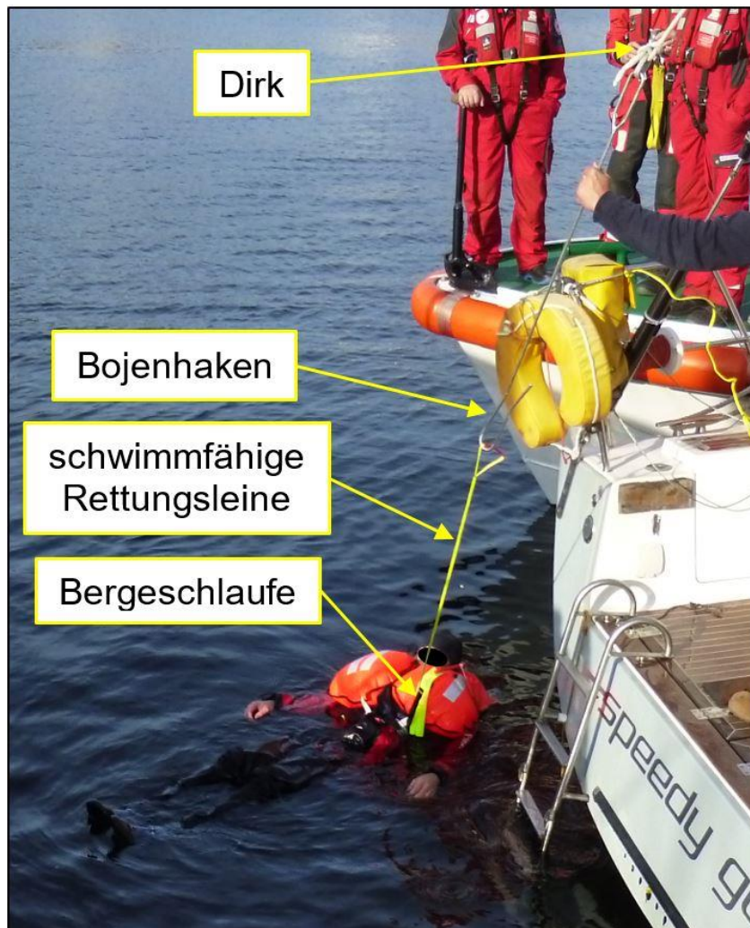
Abbildung 27: Rettung mittels an der Dirk befestigtem Bojenhaken 101
