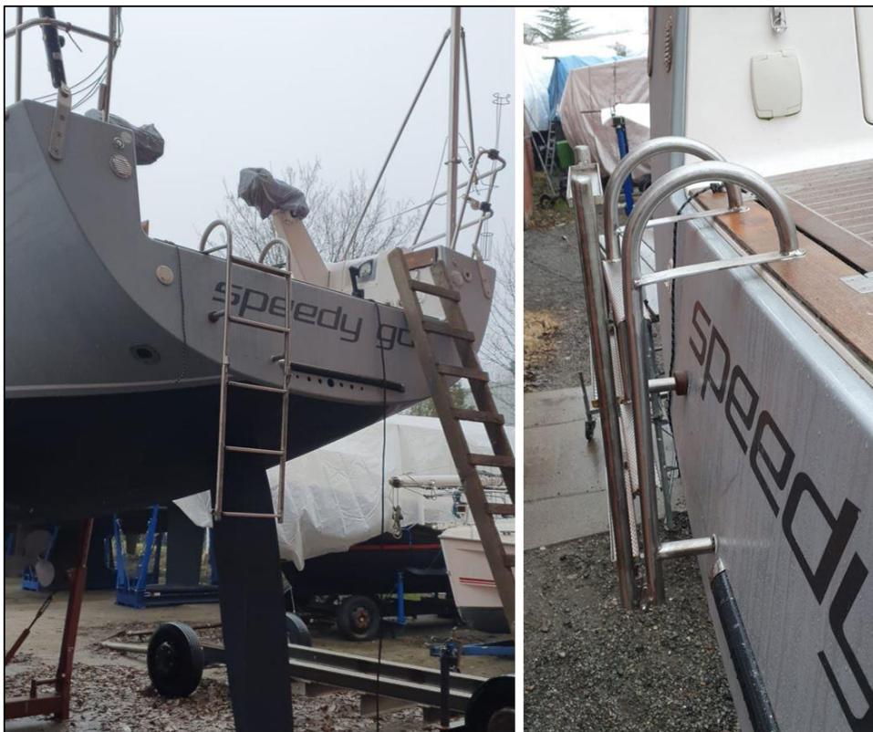
Abbildung 40: Festmontierte Badeleiter der SPEEDY GO nach Umbau 135
