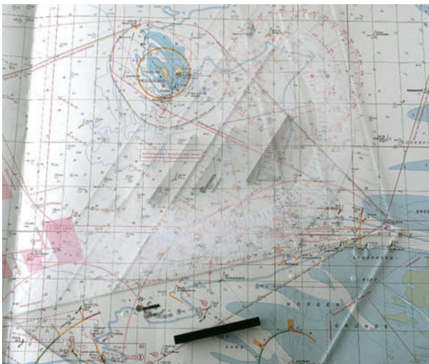
Das Anlegedreieck an die Winkelskala des Kursdreiecks anlegen. Daran das Kursdreieck verschieben, bis die Zentimeterskala durch den gewünschten Ort verläuft.
