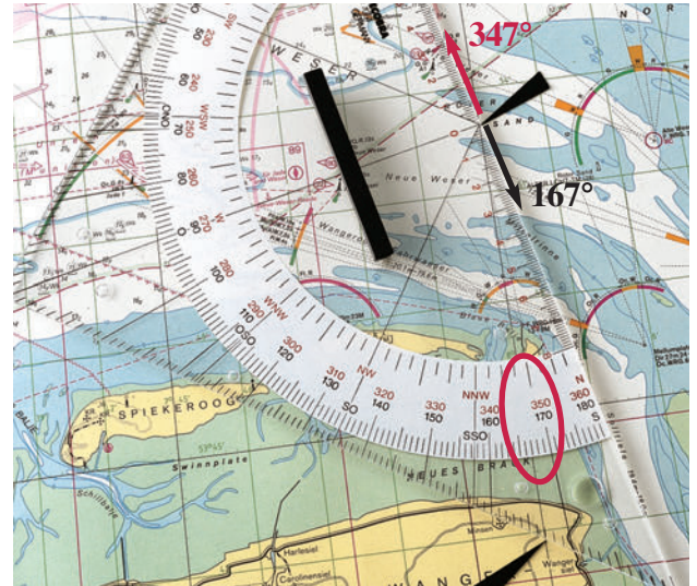
Kurs 167° (schwarze Zahl) verläuft entlang der Zentimeter-skala nach rechts unten, 347° (rote Zahl) nach links oben.
