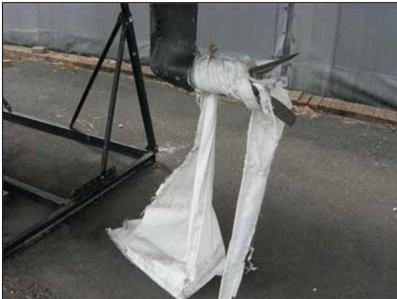
Abbildung 7: Propellerblockierung
