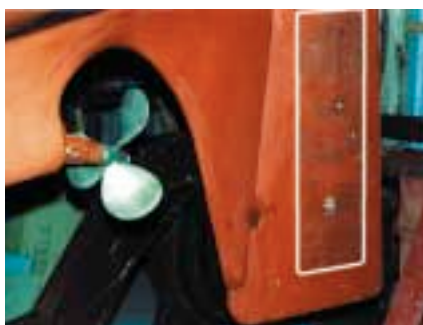
Beispiel einer Teilerdung am Ruder
