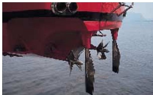
Zwillingsschrauben einer Riva Ferrari. Die Schrauben drehen gegenläufig (beide nach außen), so dass sich die jeweiligen Radeffekte (s. Seite 132) gegenseitig aufheben.
