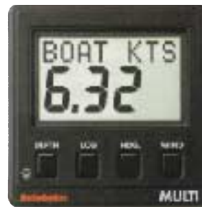
Multifunktionsanzeige für Wassertiefe, Geschwindigkeit sowie Kurs- und Windinformationen.
