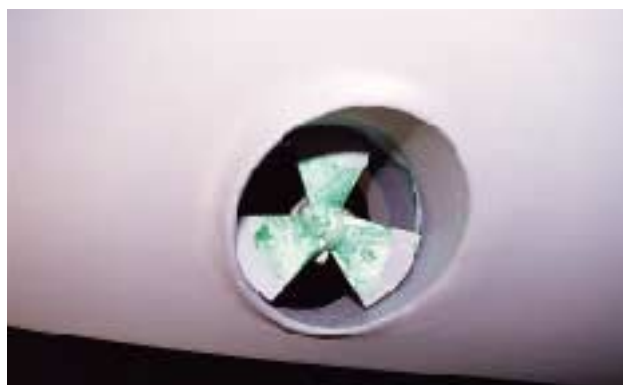
Bugstrahlruder, eine im Bug befindliche Röhre mit einem Propeller, der durch Querschub beim An- und Ablegen hilfreich ist und ein Drehen auf engem Raum ermöglicht.
