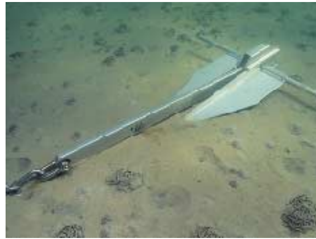
Ein Plattenanker ist auf Sand gefallen ...
