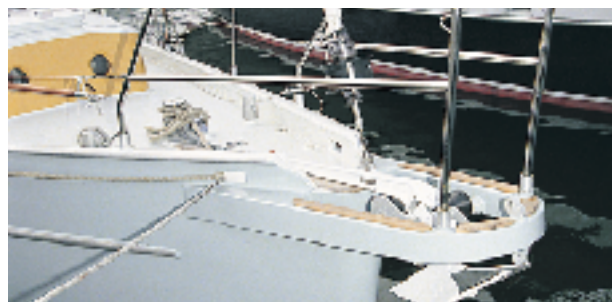
CQR-Anker in einer Ankerhalterung, dahinter Ankerspill.
